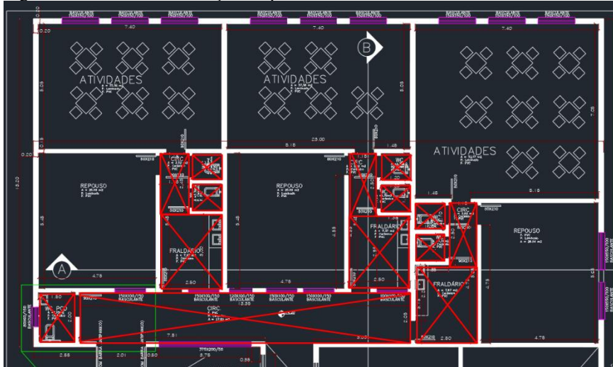
Figura 02 – Local de instalação do piso cerâmico.
