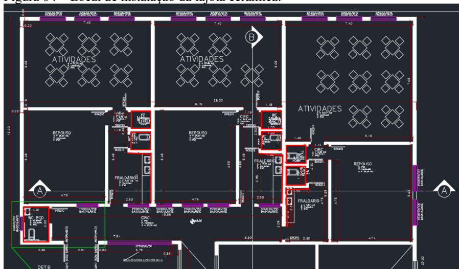
Figura 04 – Local de instalação da lajota cerâmica.
